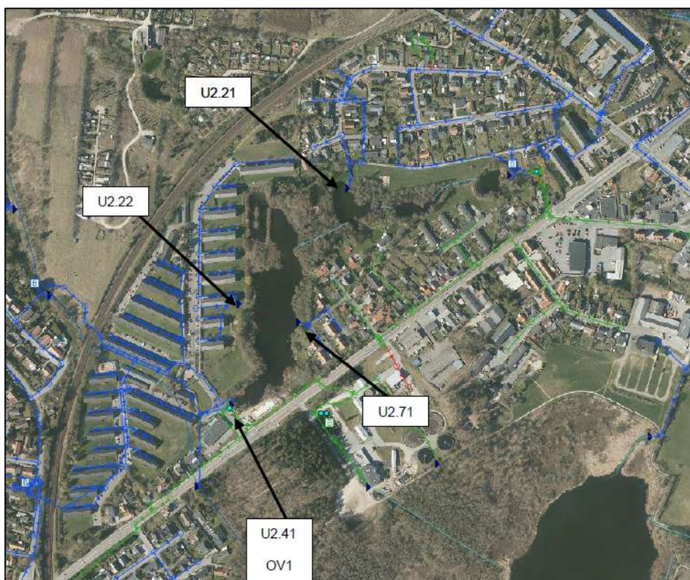
Figur 1 Oversigt over ledningsnettet i tilknytning til Eskebæk Mose samt placering af overløb og udløb.
